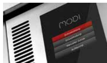
Steuerung mittels 4,3" Touchscreen
