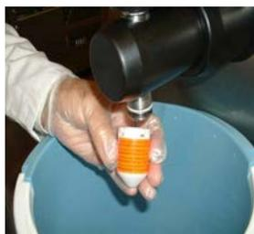
Setzen Sie die Reinigungsdüse auf
