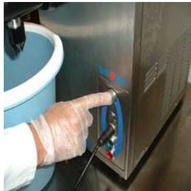
Drücken Sie den Taster Hand bis das Saugrohr entleert ist
