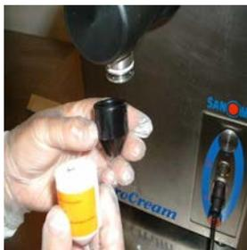
Ersetzen Sie die Reinigungsdüse durch die Garniertülle
