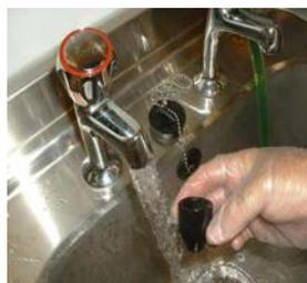
Reinigen Sie die Garniertülle unter fließend heißem Wasser
