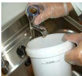
Reinigen Sie den Spültopf und füllen Sie 1,5 L kaltes Wasser ein
