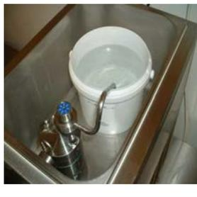
Stellen Sie den Spültopf in die Maschine und schwenken das Saugrohr ein
