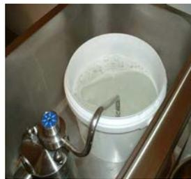
Stellen Sie den Spültopf in die Sahnemaschine und schwenken das Saugrohr ein
