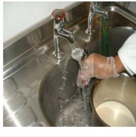
Entnehmen Sie Sahnetopf und Saugrohr und spülen Sie beides gründlich unter fließend heißem Wasser
