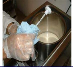
Legen Sie ein Papiertuch um das Saugrohr, schwenken Sie es hoch und reinigen Sie es mit dem Tuch
