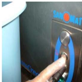
Drücken Sie mehrmals den Taster Hand (Intervall-Spülung) bis der Spültopf leer ist / Typ RA: Betätigen Sie die Reinigungstaste. Das Vorreinigungsprogramm läuft ab
