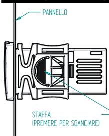
Die Tafelbau-Geräte XR70C sind für einen Ausschnitt 71x29 mm vorgesehen und werden mit zwei Befestigungsbügel fixiert. Die Befestigungsbügel von hinten aufschieben und durchschieben bis beide Bügel fest einrasten. Die Umgebungstemperatur für einen einwandfreien Betrieb sollte zwischen 0 und 60 °C liegen. Vermeiden Sie starke Vibrationen, aggressive Gase, hohe Verschmutzung oder Feuchte. Für ausreichende Belüftung der Kühlschlitze muss gesorgt werden.
