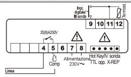
Bei 12Vac/dc, 24Vac/dc, 110Vac und 230Vac: Anschlüsse 7 und 8. Termostat.: Fühler 1, standardmässig der Raumfühler (Klemme 11 und 12) Digitaler Eingang: Klemme 9 und 11 (od. 3. Fühler)
